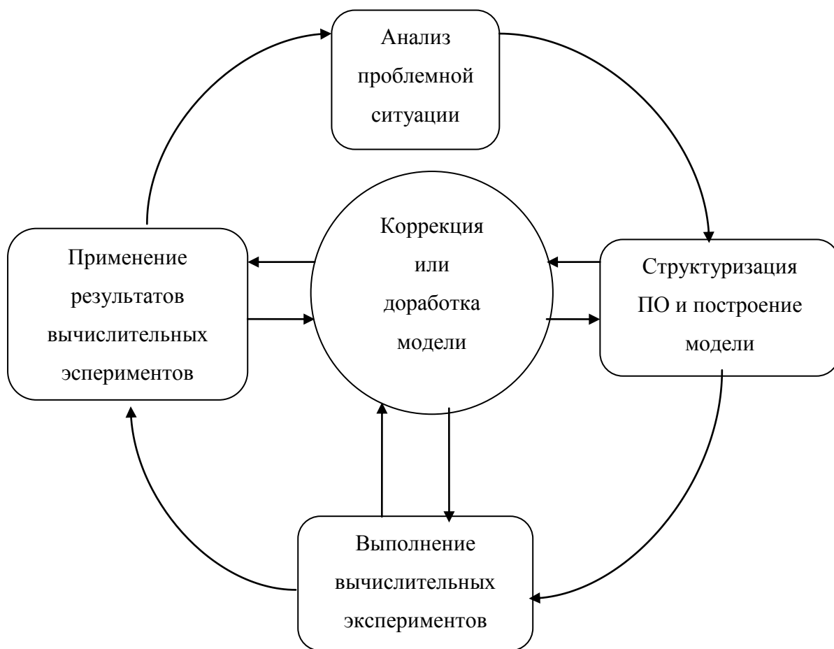
Рис. 1.2. Общая концептуальная схема процесса моделирования
