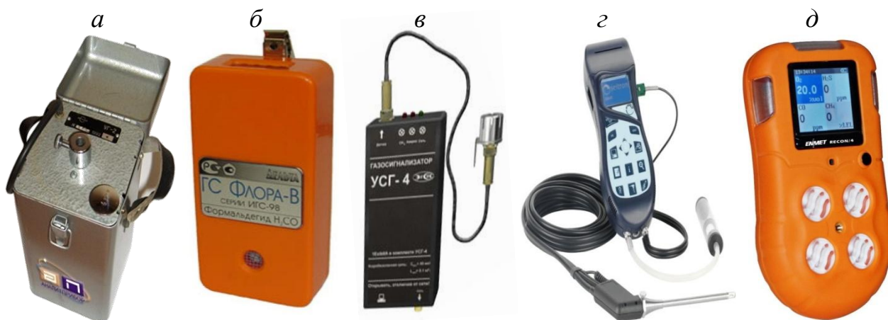
Рис. 2. Классическое (а) и современное (б-д) оборудование для анализа загазованности воздушной среды. а – универсальный газоанализатор «УГ-2»; б – переносной газосигнализатор формальдегида «Флора-В-ЖКИ»; в – газосигнализатор углеводородов «УСГ-4»; г – газоанализатор бензинов «Seitron Chemist 200 PLUS AS0625A»; д - переносной газоанализатор-детектор монооксида углерода, сероводорода и углеводородов «BX616».
