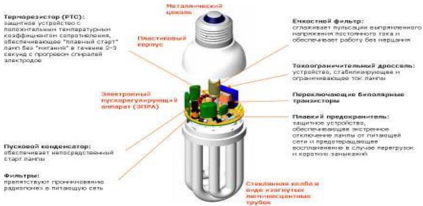
Рис. 12. Некоторые элементы конструкции компактной люминесцентной лампы
