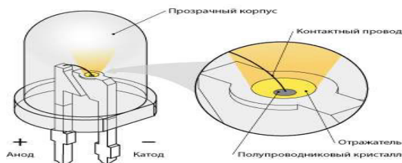
Рис. 11. Упрощенная форма исполнения светодиода
