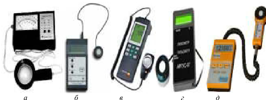
Рис. 19. Классическое (а) и современное (б–д) оборудование для измерения светотехнических величин: а – люксметр «Ю-116»; б – люксметр-пульсметр «ТКА-Пульс»; в – люксметр «Testo-545»; г – люксметр-пульсметр «Аргус-07»; д – люксметр-яркомер-пульсметр «Эколайт-02»
