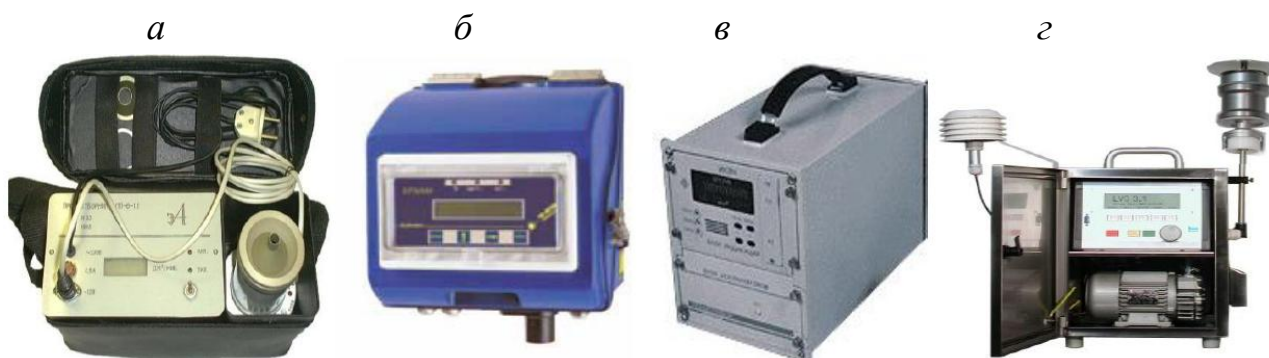
Рис. 1. Классическое (а) и современное (б-г) оборудование для анализа запыленности воздушной среды. а – пробоотборник пыли (аспиратор) «АПП-6»; б – анализатор пыли «EP1000A (WE1ASCS)»; в – стационарный измеритель концентрации взвешенных частиц «ИКВЧ»; г – анализатор микро- и ультрамикроскопической пыли, а также диоксинов «LVS 3.1».
